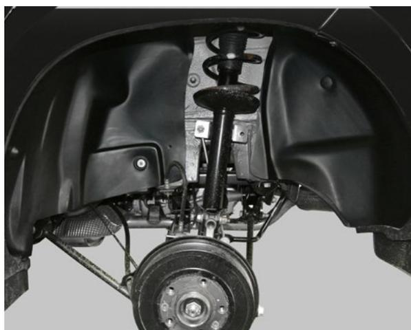
Подкрылок (локер) – пластиковый кожух, устанавливаемый в колесную арку автомобиля, защищающий кузов от негативного влияния внешней среды.
